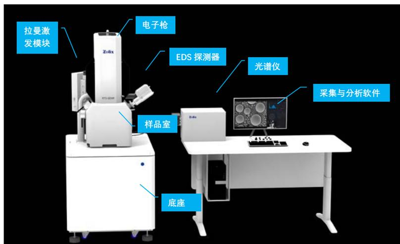
拉曼集成扫描电子显微镜采用平行双束方案, 搭载高精度复合位移台可实现样品在拉曼光轴和电子束光轴之间快速、精确、稳定的切换, 拉曼扫描范围高达 2.5 mm。
